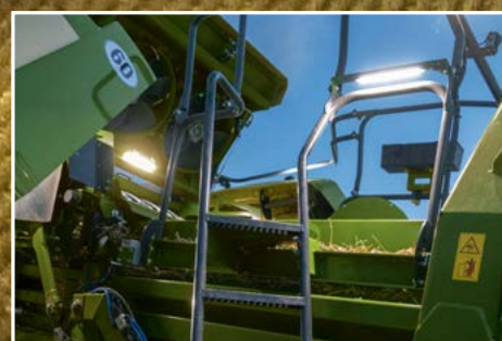
Éclairage de l'échelle d'accès
