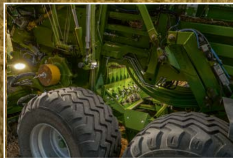
Eclairage des aiguilles
