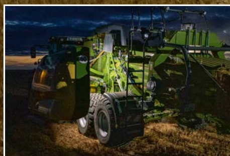
Éclairage derrière les boîtes à ficelle
